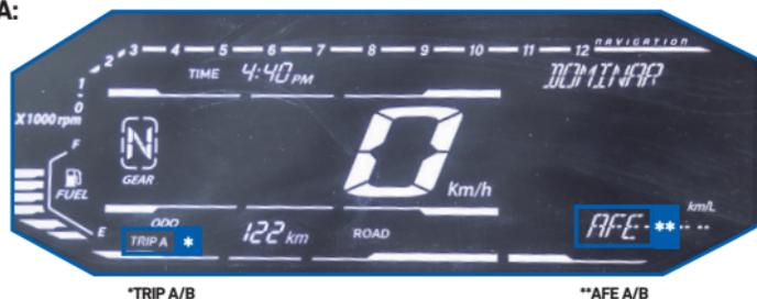
**OBSERVAÇÃO:** O valor do AFE será atualizado a cada 60 segundos. O AFE será reiniciado se o respectivo TRIP A ou TRIP B for reiniciado ou se a bateria for desconectada.
